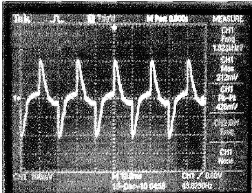
รูปที่ 4.4 สัญญาณออกดีโอด้านซ้ายทางด้านอินพุต
