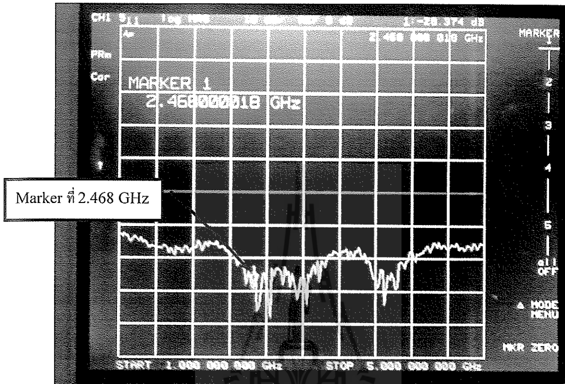
รูปที่ 4.20 การทดสอบ S11 สายอากาศวิทยาก็ด้วยเครื่อง Network Analyzer
