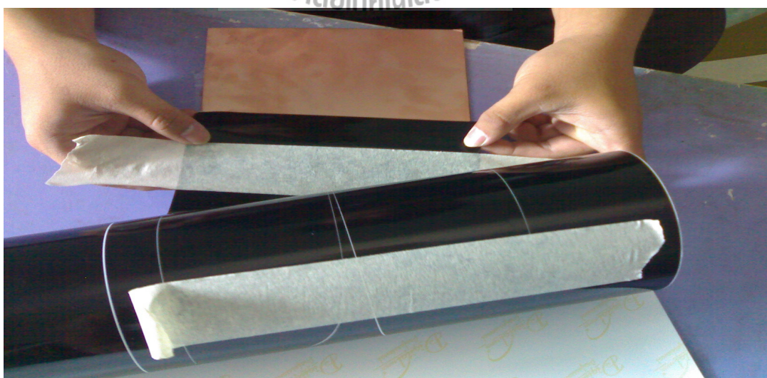
รูปที่ 4.6 การติดสติ๊กเกอร์ลงบนแผ่น FR4
