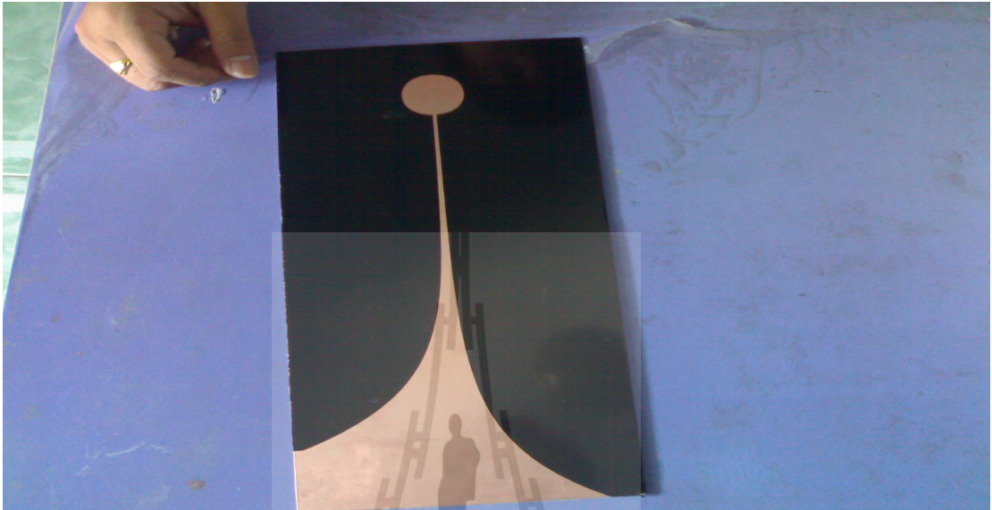
รูปที่ 4.7 แผ่น FR4 ที่ติดสติ๊กเกอร์เรียบร้อยแล้ว
