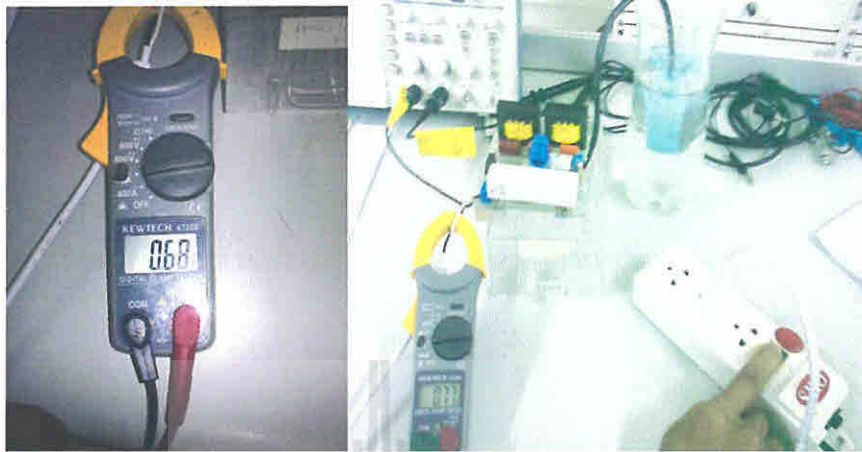
รูปที่ 4.2 แสดงการวัดค่าการกินกระแสของ Oscillator
