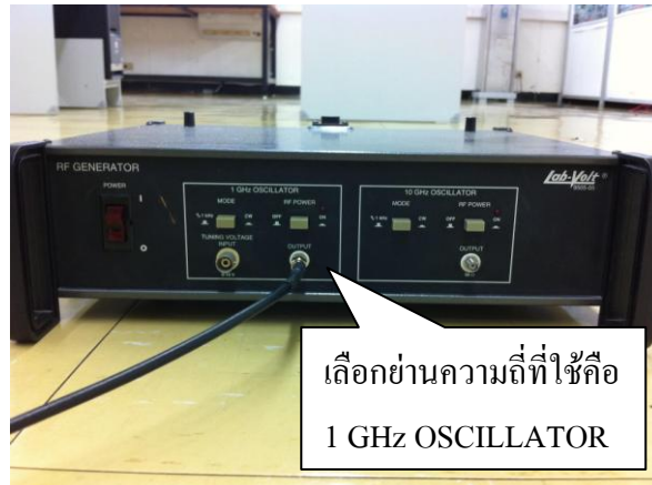
รูปที่ 4.4 แสดงการเลือกใช้ความถี่บนเครื่องส่ง (Generator)
