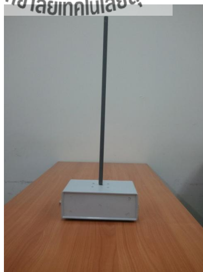
รูปที่ 3.8 ชุดควบคุมการหมุนของสายอากาศด้วยสเต็ปมอเตอร์
