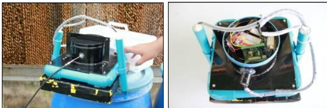
รูปที่ 4.5 ส่วนประกอบวงจรรภายในของตู้กรอง
