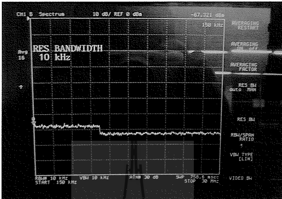
รูปที่ 4.27 แสดงผลการวัด spurious ที่ความถี่ 150 kHz - 30 MHz
