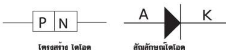
รูปที่ 2.14 โครงสร้างและสัญลักษณ์ของไดโอด
