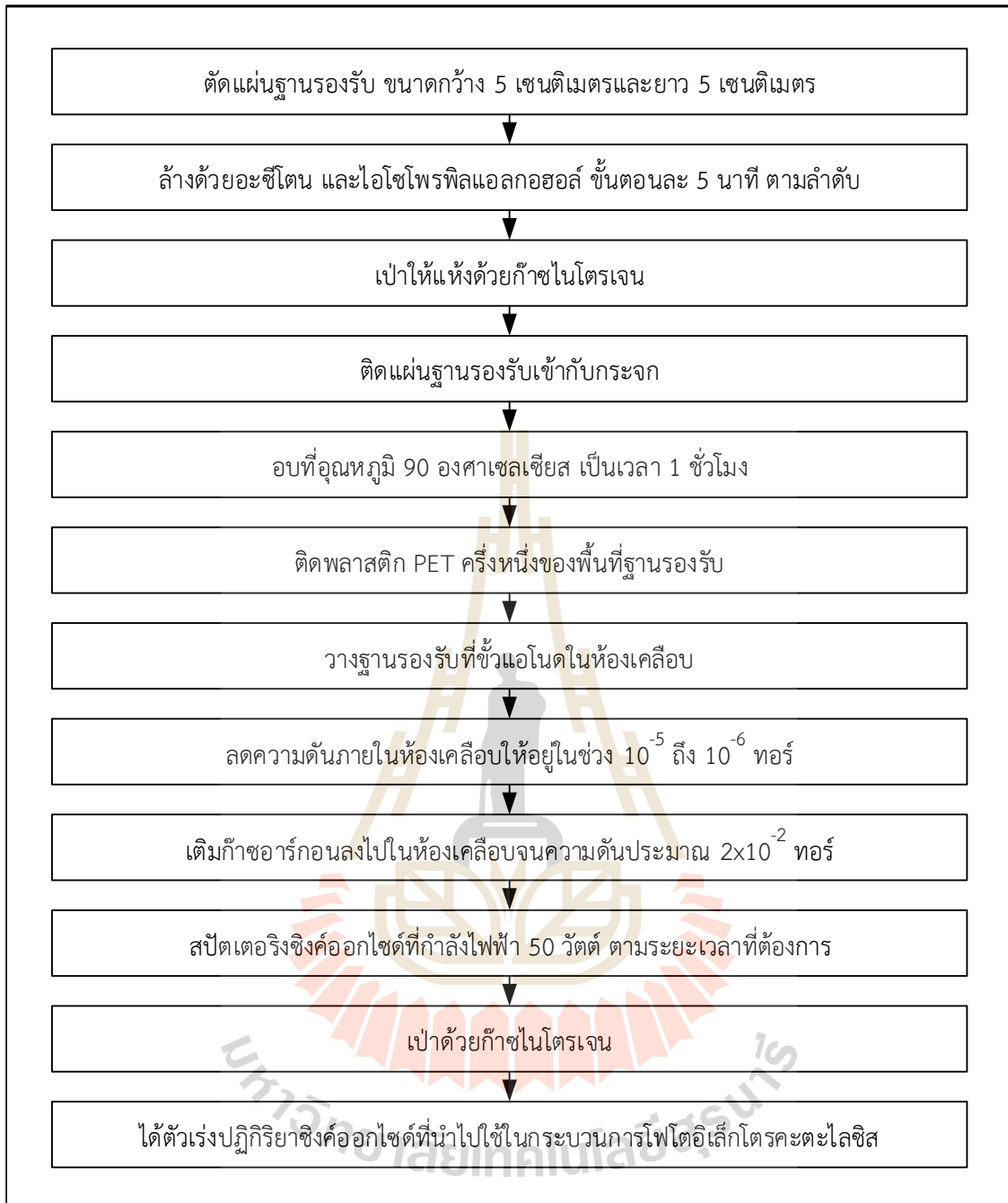
รูปที่ 3.14 1 วิธีการสังเคราะห์ซิงค์ออกไซด์ด้วยกระบวนการสปีดเตอริง
