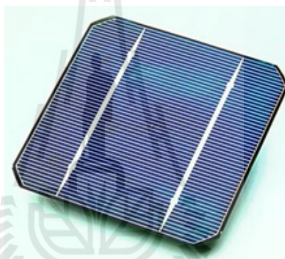
รูปที่ 2.1 เซลล์สุริยะผลิตจากชั้นผลึกคริสตัลชั้นเดียวที่เรียกว่า a monocrystalline silicon wafer ที่มี contact grid ที่ทำจาก busbars (แถบใหญ่) และ fingers (แถบเล็ก) [3]
