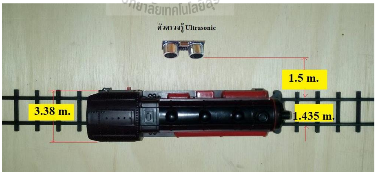
รูป3.5 ระยะทางระหว่างตัวตรวจรู้ Ultrasonic กับ รางรถไฟ
