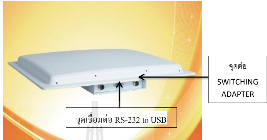
รูปที่ 2.9 แสดงจุดเชื่อมต่อของเครื่องอ่าน RFID
