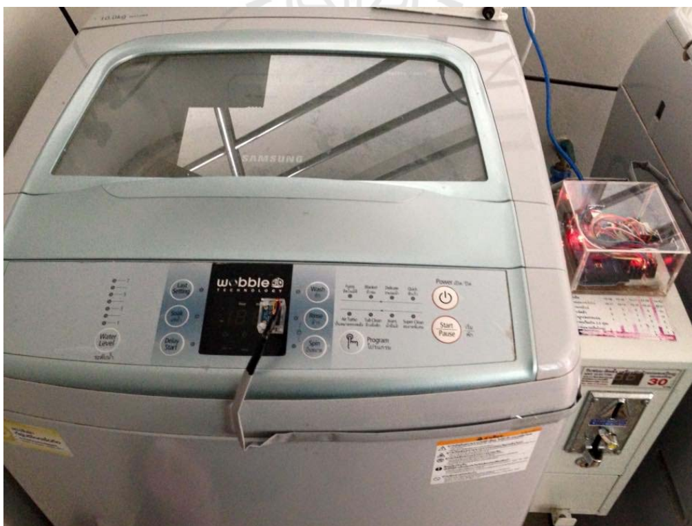
รูปที่ 4.19 แสดงการติดตั้ง Light Sensor เข้ากับ Monitor ของเครื่องซักผ้า
