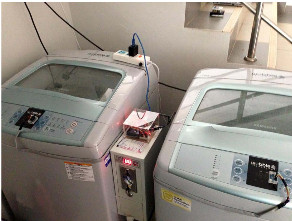
รูปที่ 4.18 แสดงการติดตั้งอุปกรณ์เข้ากับเครื่องซักผ้าอัตโนมัติ
