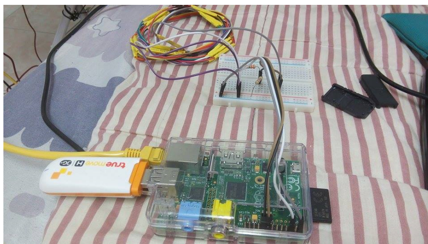
รูปที่ 3.10 การเชื่อมต่ออุปกรณ์ USB Air card ให้บอร์ด Raspberry pi
