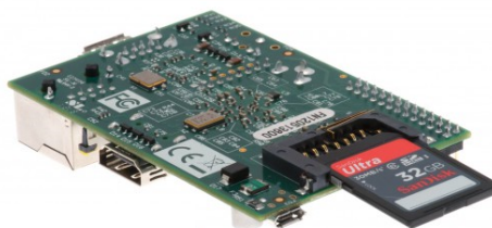
รูปที่ 2 เชื่อมต่อ SD card กับบอร์ด Raspberry Pi
