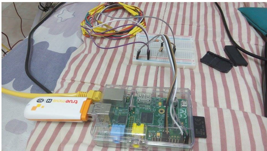
รูปที่ 5 การเชื่อมต่ออุปกรณ์ USB Air card ให้บอร์ด Raspberry pi
