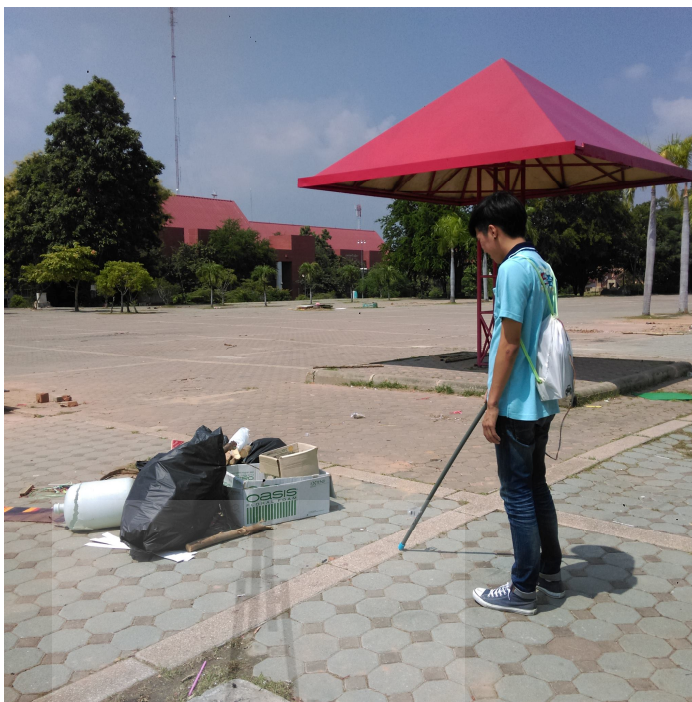
รูปที่ 4.2 การทดสอบการแจ้งเตือนของระยะห่างระหว่างวัตถุของตัว Ultrasonic Sensor
