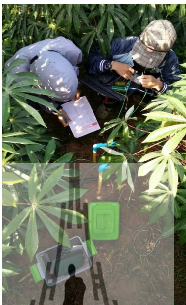
รูปที่ 4.1 การวัดค่ากล้องอ่านค่ากับเซ็นเซอร์ WATERMARK
