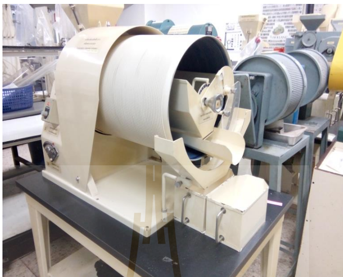
รูปที่ 3.11 เครื่องตัดแยกเมล็ดพันธุ์ยาว-สั้น ทรงกระบอก
