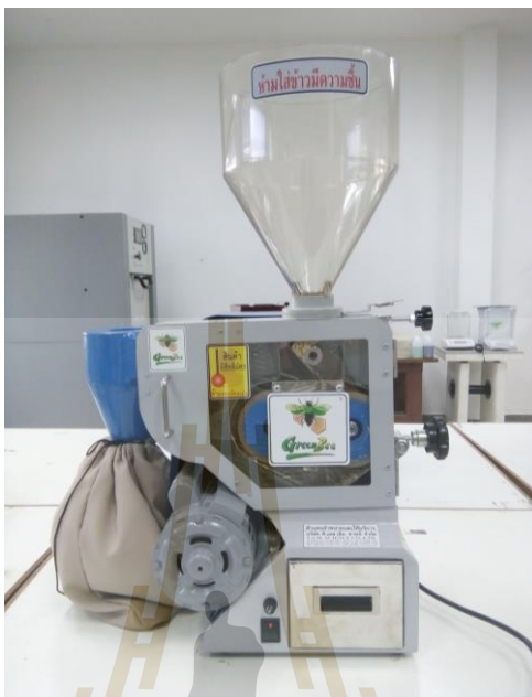
รูปที่ 3.9 เครื่องกะเทาะข้าวกล้อง รุ่น NW-150
