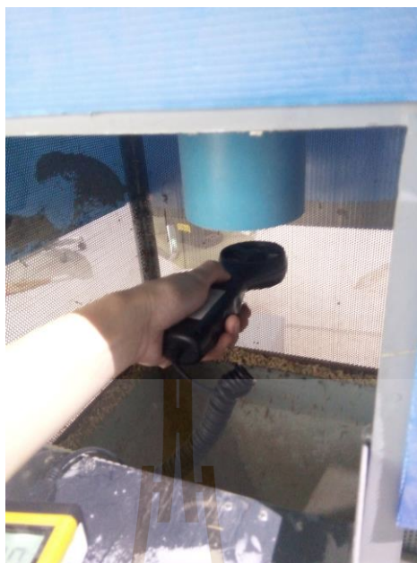
รูปที่ 3.15 วัดความเร็วลมจากปลายท่อห้องอบแห้งเพื่อหาอัตราการไหลของข้าวเปลือก
