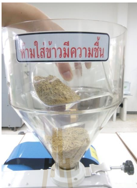
รูปที่ 3.18 นำข้าวเปลือกใส่ลงในภาชนะของเครื่องกะเทาะเปลือกออก
