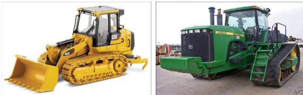
รูปที่ 2.64 ลักษณะรถแทรกเตอร์ล้อตีนตะขาง ซ้ายมือเป็นภาพล้อตีนตะขางเหล็ก ขวามือเป็นภาพล้อตีนตะขางยาง
