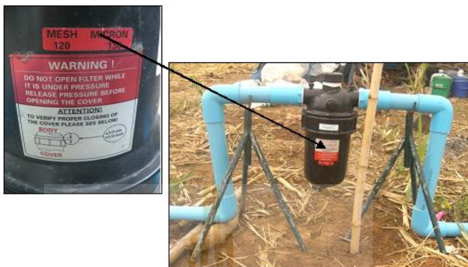
รูปที่ 2.69 ขนาดความละเอียดของไส้กรองที่ระบุไว้ที่เครื่องกรองน้ำสำหรับน้ำหยด
