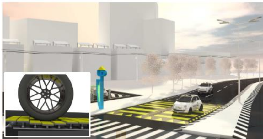
รูปที่ 2.28 เครื่องต้นแบบสันชะลอความเร็วประยุกต์ใช้งานร่วมกับเครื่องกำเนิดไฟฟ้าแนวตั้ง
