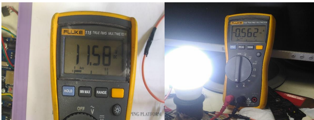
ก. แรงดันไฟฟ้าที่สามารถวัดได้จากมัลติมิเตอร์ ข. กระแสไฟฟ้าที่สามารถวัดได้จากมัลติมิเตอร์
