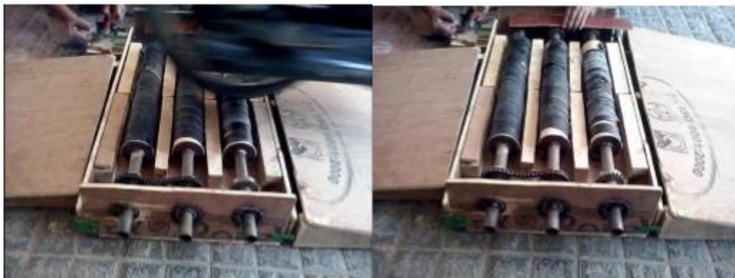
รูปที่ 2.36 เครื่องต้นแบบสันชะลอความเร็วประยุกต์ใช้กลไกแบบล้อ
