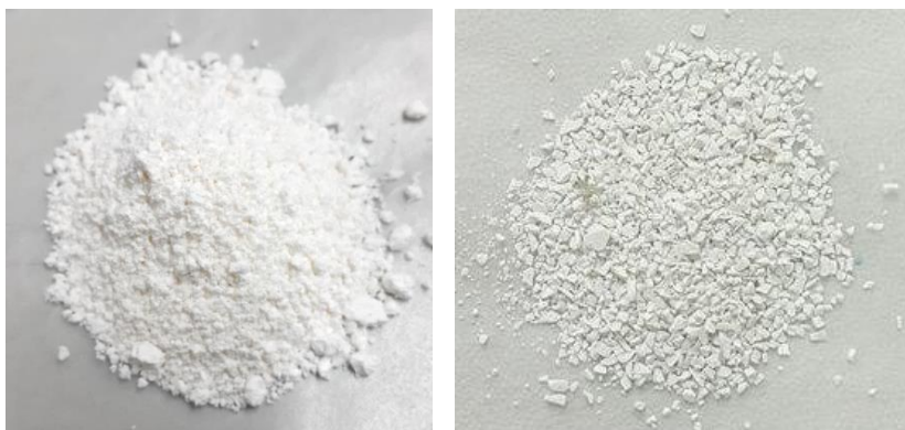
รูปที่ 4.20 ผงซีโอไลต์ที่สังเคราะห์ได้ และเกล็ดซีโอไลต์ที่ใช้ในการทดสอบ (250-600 \mu\text{m} )
