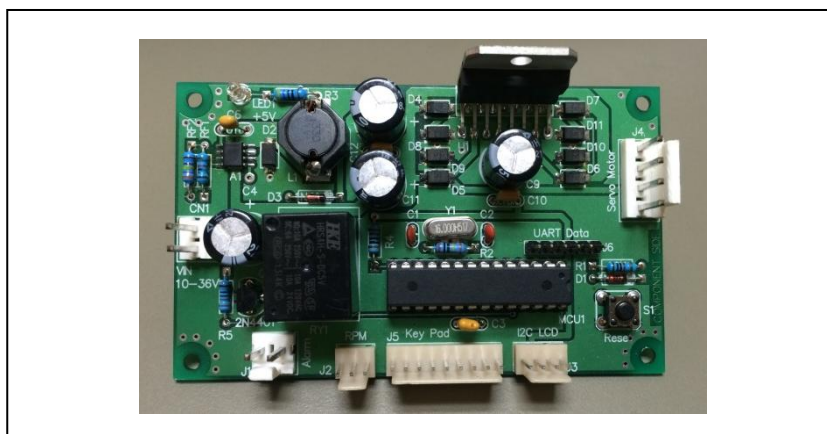
รูปที่ 4.2 บอร์ดควบคุมและชุด Power Amplifier
