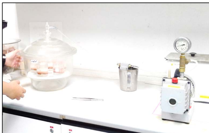
รูปที่ 3.10 แสดงการวัดความดันอากาศในห้องปฏิบัติการด้วยเครื่องวัดความดันอากาศและหม้อสุญญากาศ
