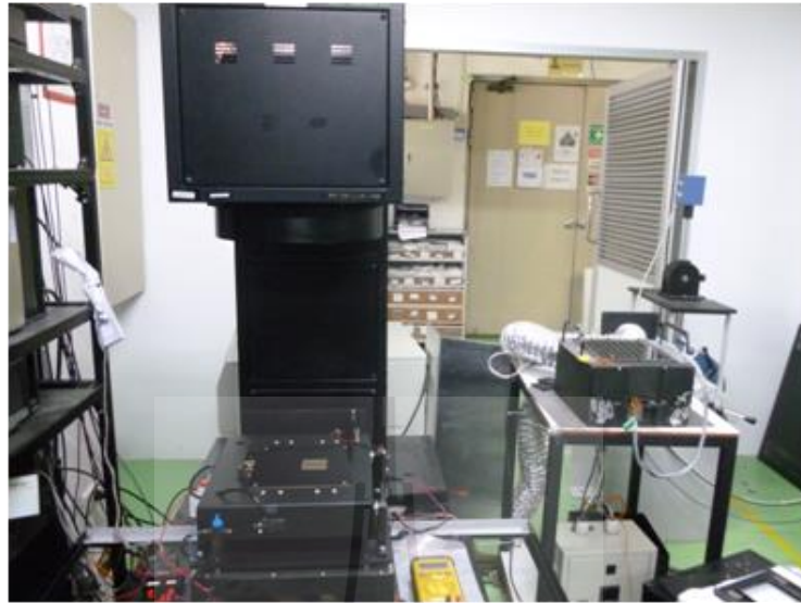
รูปที่ 5.7 ระบบการวัดประสิทธิภาพการแปลงพลังงานของเซลล์แสงอาทิตย์ด้วยเครื่อง Solar simulator
