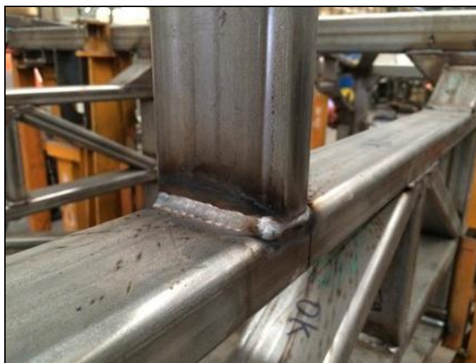
รูปที่ 3.29 แสดงลักษณะรอยเชื่อมของ โครงสร้างรถโดยสารไฟฟ้า
