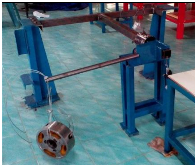
รูปที่ 3.12 แสดงการทดสอบการเสียรูปของชิ้นงานเนื่องจากโมเมนต์ดัดรอบแกน X
