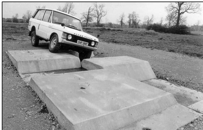
รูปที่ 2.17 แสดงตัวอย่างพฤติกรรมที่ทำให้เกิดสภาวะแรงบิด
