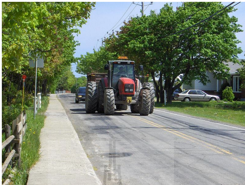
รูปที่ 2.4 แสดงลักษณะการเกิดคอขวดแบบเคลื่อนที่
