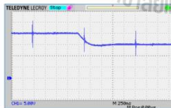
รูปที่ 12 ผลทดสอบเมื่อระดับแรงดันเอาต์พุตที่ต้องการเปลี่ยนจาก 20 โวลต์ เป็น 15 โวลต์
