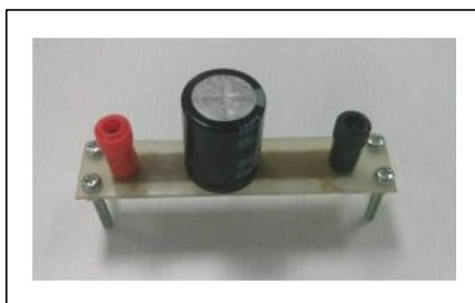
รูปที่ 5.6 ตัวเก็บประจุที่ใช้ในวงจรลดทอนระดับแรงดันที่พัฒนาขึ้น
