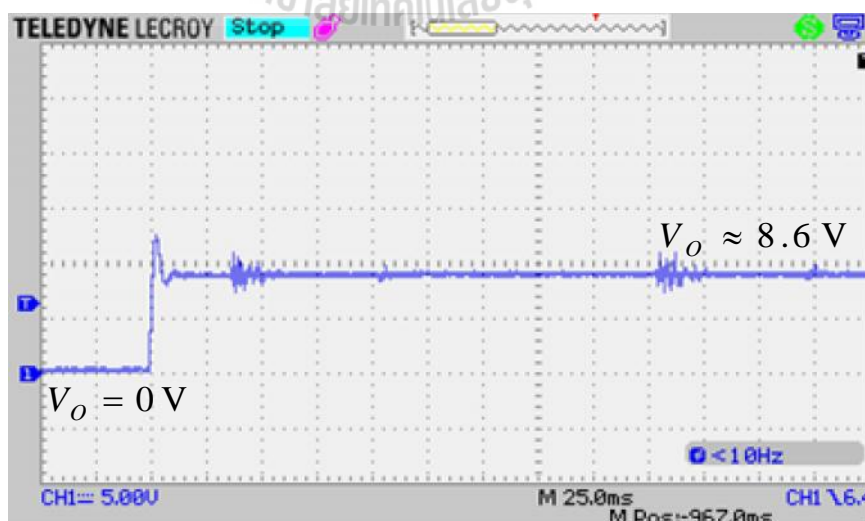
รูปที่ 6.12 ผลการทดสอบแรงดันเอาต์พุตที่ค่าวัฏจักรหน้าที่ 0.25
