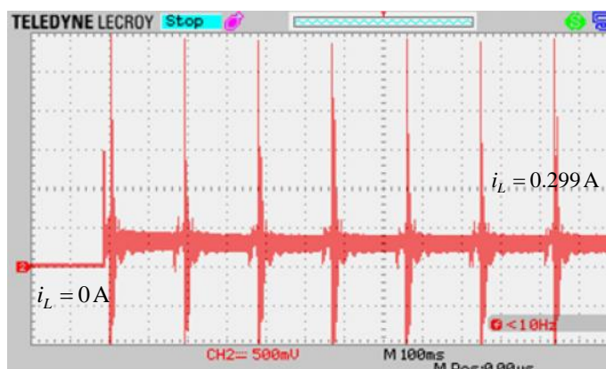
รูปที่ 6.6 ผลการทดสอบกระแส i_L ที่ค่าวัฏจักรหน้าที่ 0.15
