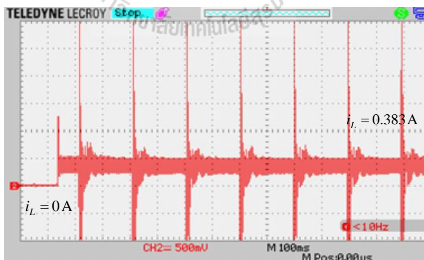
รูปที่ 6.10 ผลการทดสอบกระแส i_L ที่ค่าวัฏจักรหน้าที่ 0.20
