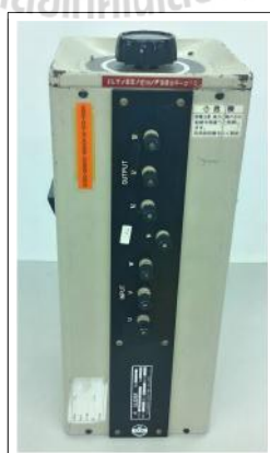
รูปที่ 5.9 หม้อแปลงปรับแรงดันสามเฟส
