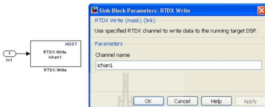
รูปที่ ข.5 การกำหนดค่าบล็อก RTDX Write
