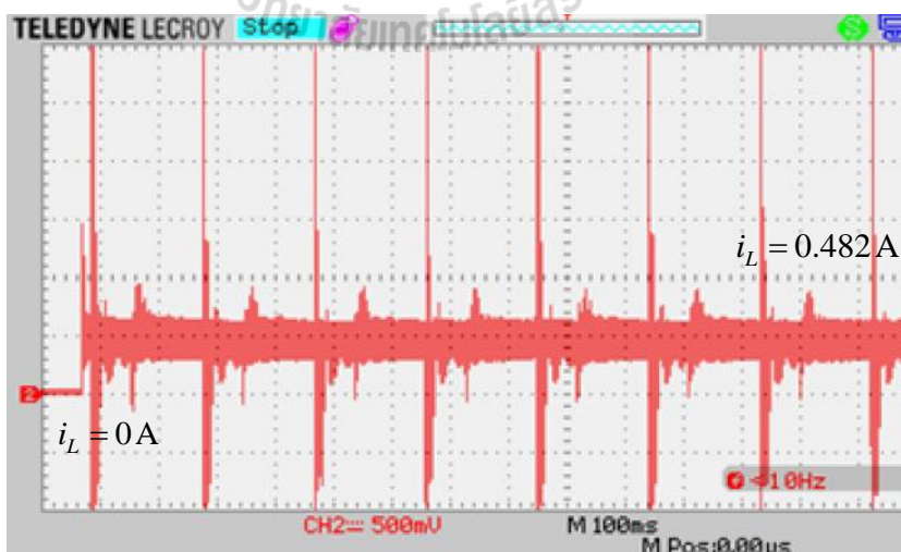
รูปที่ 6.14 ผลการทดสอบกระแส i_L ที่ค่าวัฏจักรหน้าที่ 0.25
