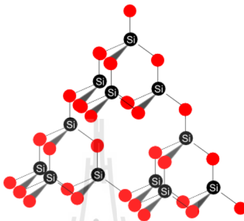
รูปที่ 2.6 โครงสร้าง \text{SiO}_2 แบบผลึกร่างตาข่าย
