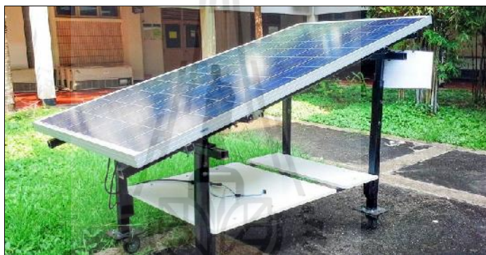
รูปที่ 6.1 การติดตั้งแผงพีวี Hanwha solar รุ่น SF260, 295 W บนฐานรองที่เคลื่อนย้ายได้
