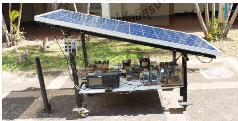
รูปที่ 7.13 การทดสอบชุดวงจรต้นแบบทั้ง 2 ภาคที่มีการเชื่อมต่อกริดภายใต้แสงอาทิตย์จริง
