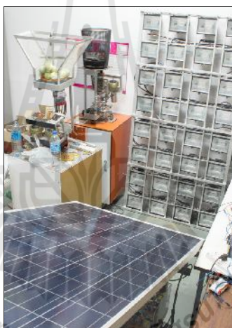
รูปที่ 7.2 ชุดโคมไฟหลอดไอโอดีนที่ใช้สร้างแสงอาทิตย์เทียม
