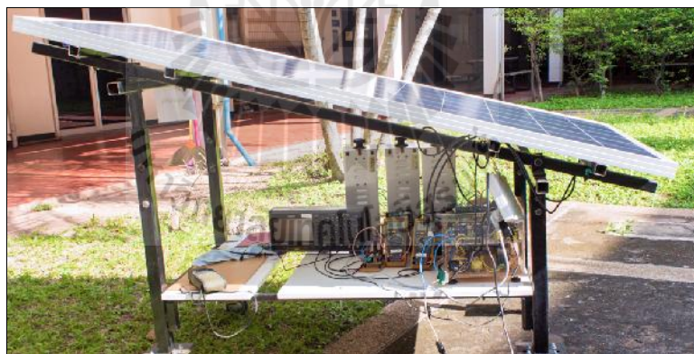
รูปที่ 7.4 การทดสอบวงจรแปลงผันบูสต์ที่มีหน่วยเอ็มพีพีทีร่วมกับแผงพีวีภายใต้แสงอาทิตย์จริง
