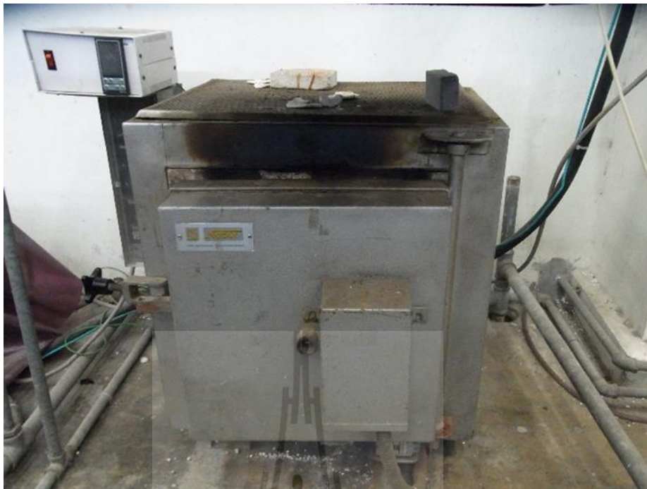
รูปที่ 3.7 เตาขดลวดสำหรับขั้นตอนการอบละลาย
