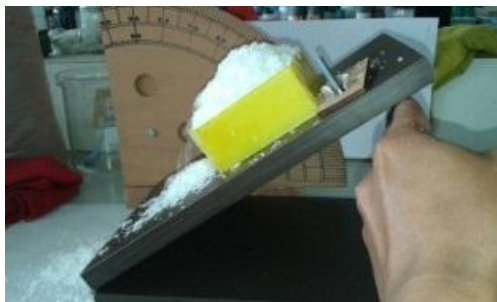
รูปที่ 3.9 การหามุมเสียดทานภายในของมะพร้าวขูด
