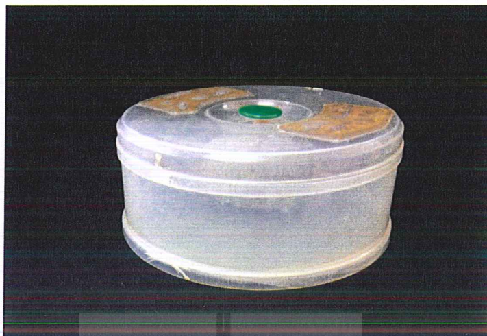
ภาพที่ 3.4 ก่องพลาสติกกลมใสขนาดเส้นผ่านศูนย์กลาง 23 เซนติเมตร สูง 10 เซนติเมตร พร้อมฝาปิด ที่ทำด้วยลวดตาข่ายละเอียด
