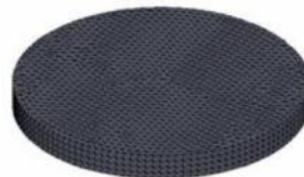
รูปที่ 2 การแบ่งอิลลิเมนต์ของหม้อแปลงไฟ้อิเล็กทริกแบบ 3 มิติ
