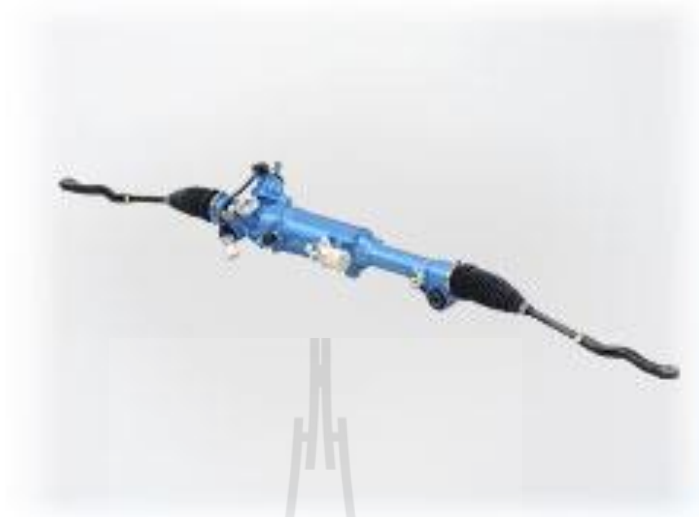
รูปที่ 2.15 rack electric power steering, rack type-EPS (ที่มา : https://www.jtekt.co.jp )
