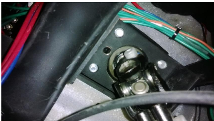
รูปที่ 3.4 ตำแหน่งน็อตตัวผู้ (bolt) ยึดแกนพวงมาลัยที่ติดตั้งจากโรงงาน
