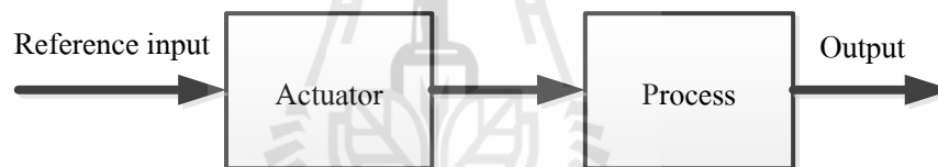
รูปที่ 2.22 แผนภาพระบบควบคุมแบบวงเปิด
