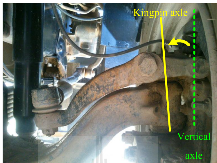
รูปที่ 2.10 ตัวอย่างมุมคิงพิน หรือมุมเอียงของแกนบังคับเลี้ยว (kingpin inclination angle)
