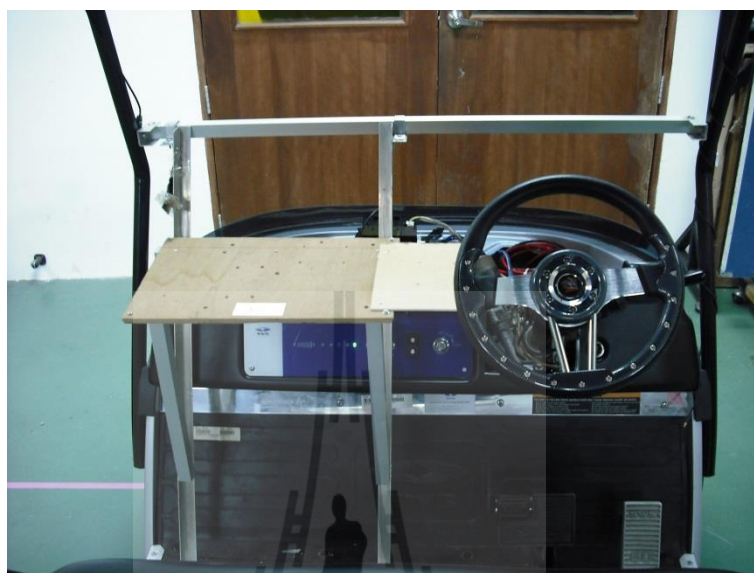
รูปที่ 3.11 รถกอล์ฟไฟฟ้าติดตั้งชุดบังคับเลี้ยวแบบช่วยแรงด้วยมอเตอร์ไฟฟ้าช่วยขับที่ชุดแกนพวงมาลัย (column type electric power steering : C-EPS)
