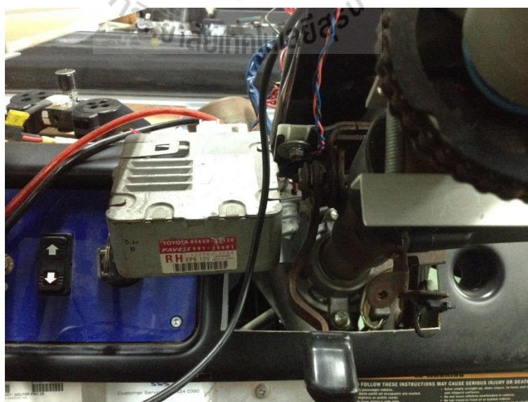
รูปที่ 3.9 ตำแหน่งติดตั้งชุดควบคุมมอเตอร์ (EPS-ECU)
