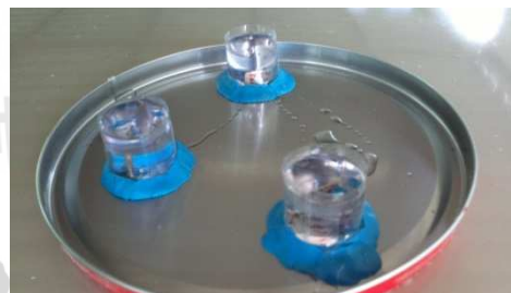
รูปที่ 3.5 แสดง ก. เรซินและสารทำให้แข็งตัว และ ข. ชิ้นงานถูกยึดด้วยเรซิน
