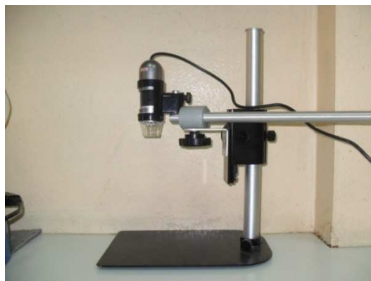
รูปที่ 3.2 กล้องDino-lite ที่ใช้ในการทดลอง
