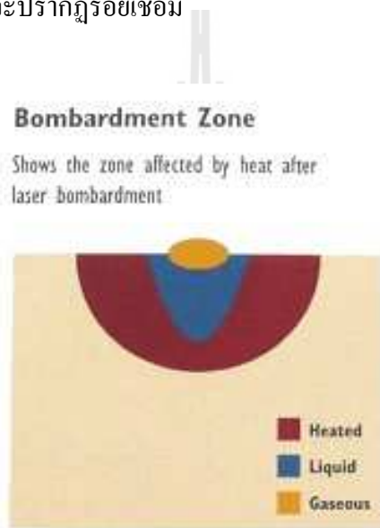
รูปที่ 2.1. รูปแสดงการเปลี่ยนแปลงของเนื้อโลหะ หลังจากที่ถูกเลเซอร์ตกกระทบ [Faerber et al., 2003]
