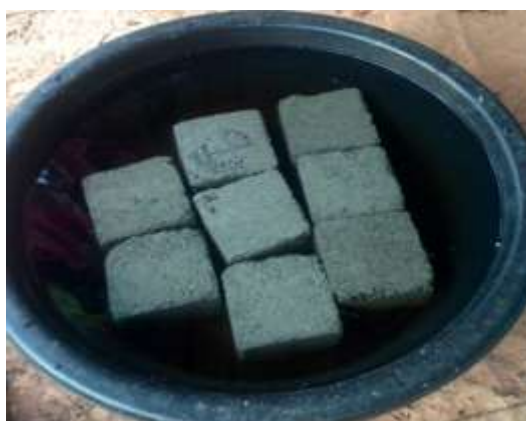
รูปที่ 3.14 การบ่มน้ำตัวอย่างคอนกรีตบล็อกเป็นเวลา 48 ชั่วโมง
