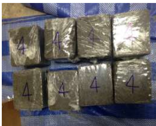
รูปที่ 3.10 ก้อนตัวอย่างคอนกรีตบล็อก
