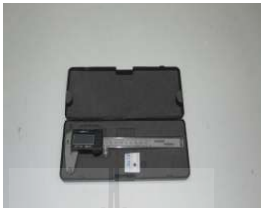
รูปที่ 3.9 เครื่องมือวัดขนาดแท่งตัวอย่างคอนกรีตบล็อก (Venire)
