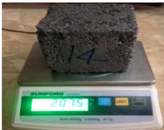
รูปที่ 3.11 การชั่งน้ำหนักตัวอย่างคอนกรีตบล็อก
