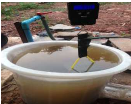
รูปที่ 3.15 การชั่งน้ำหนักคอนกรีตบดคือน้ำ
