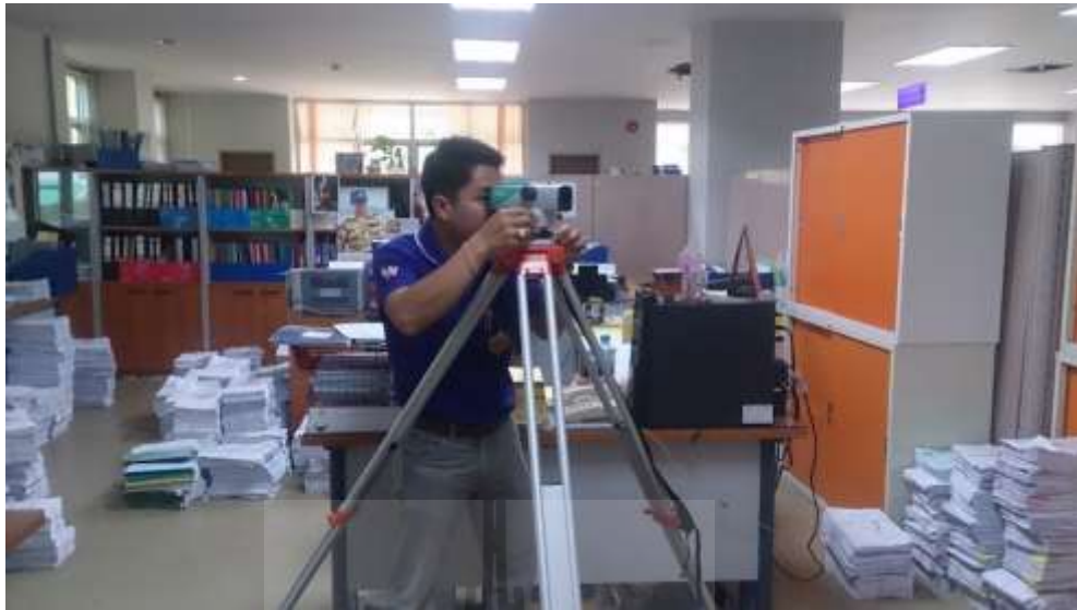
รูปที่ 4.4 การสำรวจการทรุดตัวของอาคารด้วยกล้องระดับ
