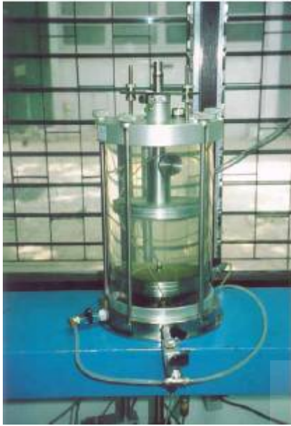
รูปที่ 2.10 ชุดทดสอบ mCPT โดยใช้ชุดทดสอบแรงอัดสามแกน (พลากร พิรภักย์, 2547)
