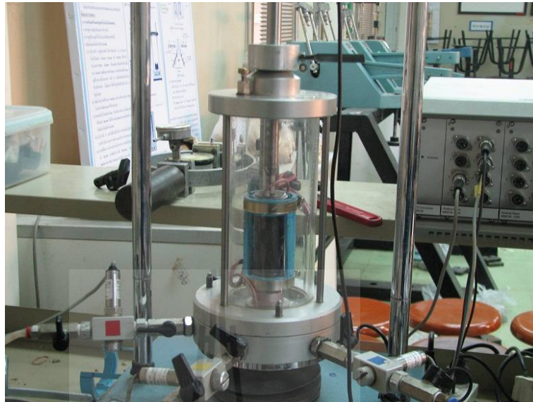
รูปที่ 4.12 การติดตั้งชุดทดสอบการทะลุทะลวงของกรวย
