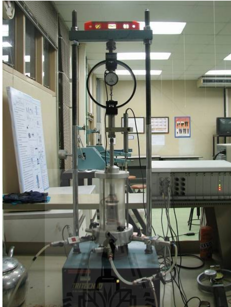
รูปที่ 4.7 การทดสอบแรงอัดสามแกนแบบไม่ระบายน้ำ
