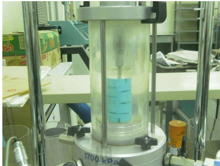
รูปที่ 4.14 การติดตั้งตัวอย่างเพื่อสอบเทียบน้ำ
