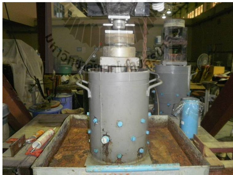
รูปที่ 4.4 การทดสอบการอัดตัวคายน้ำในแบบขนาดใหญ่
