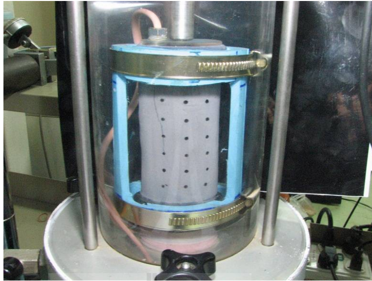
รูปที่ 4.10 ตัวอย่างดินที่พร้อมสำหรับการทดสอบการทะลุทะลวงของกรวย
