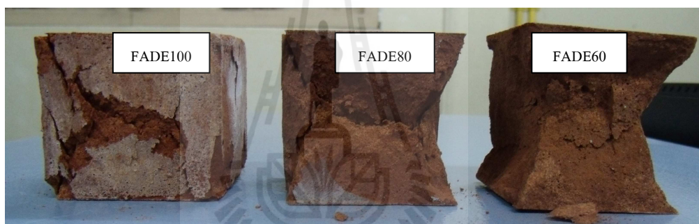
รูปที่ 4.78 ลักษณะการวิบัติของจีโอโพลิเมอร์มอร์ตาร์จากถ้ำลอยผสมโคอะตอมไมต์
