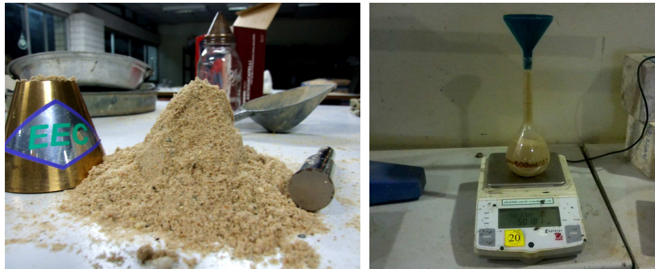
รูปที่ 3.5 การทดสอบหาค่าความถ่วงจำเพาะและค่าการดูดซึมน้ำของทราย
