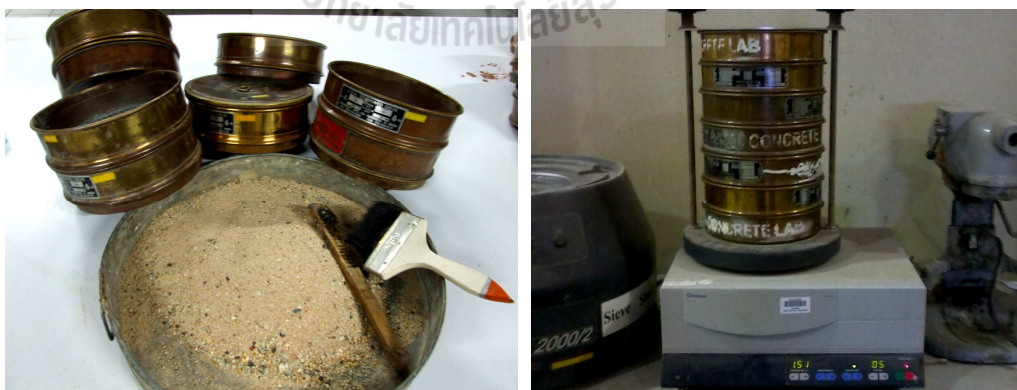
รูปที่ 3.6 การทดสอบหาขนาดคละและ โมดูลัสความละเอียดของทราย
