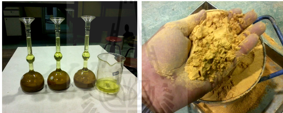
รูปที่ 3.7 การทดสอบหาค่าความถ่วงจำเพาะและหน่วยน้ำหนักของวัสดุประสาน
