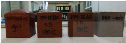
รูปที่ 12 ผลกระทบของอุณหภูมิการเร่งปฏิกิริยาต่อซีไอโพลีเมอร์มอร์ตาร์
