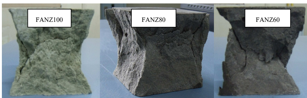
รูปที่ 4.80 ลักษณะการวิบัติของจีโอโพลิเมอร์มอร์ตาร์จากเถ้าลอยผสมซีโอไลต์ธรรมชาติ
