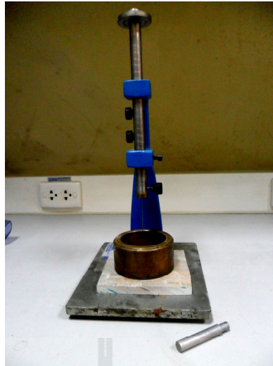
รูปที่ 3.11 ชุดทดสอบแบบไวแคต (Vicat apparatus)
