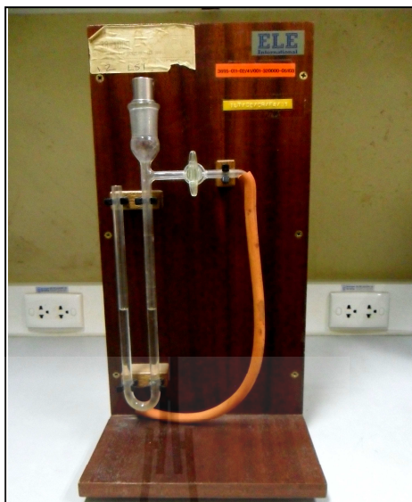
รูปที่ 3.8 ชุดทดสอบหาความละเอียดของวัสดุประสาน ด้วยวิธีของเบลน (Blaine finness)
