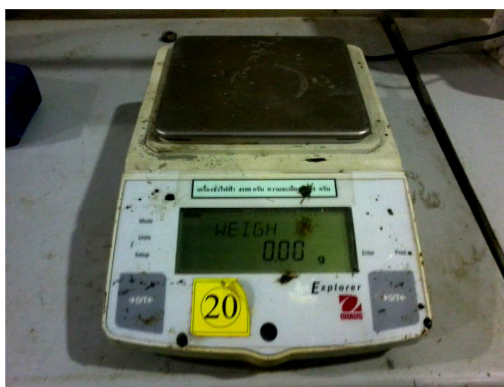
รูปที่ 3.9 เครื่องชั่งสำหรับหาหน่วยน้ำหนัก ชั่งได้ละเอียด 0.01 กรัม
