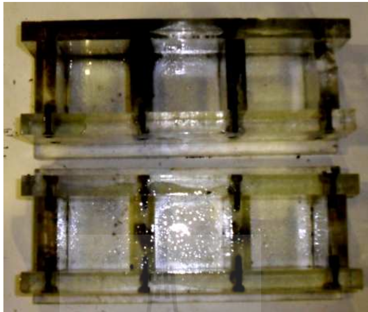
รูปที่ 3.4 แบบหล่ออะคริลิก ขนาด 50x50x50 mm
