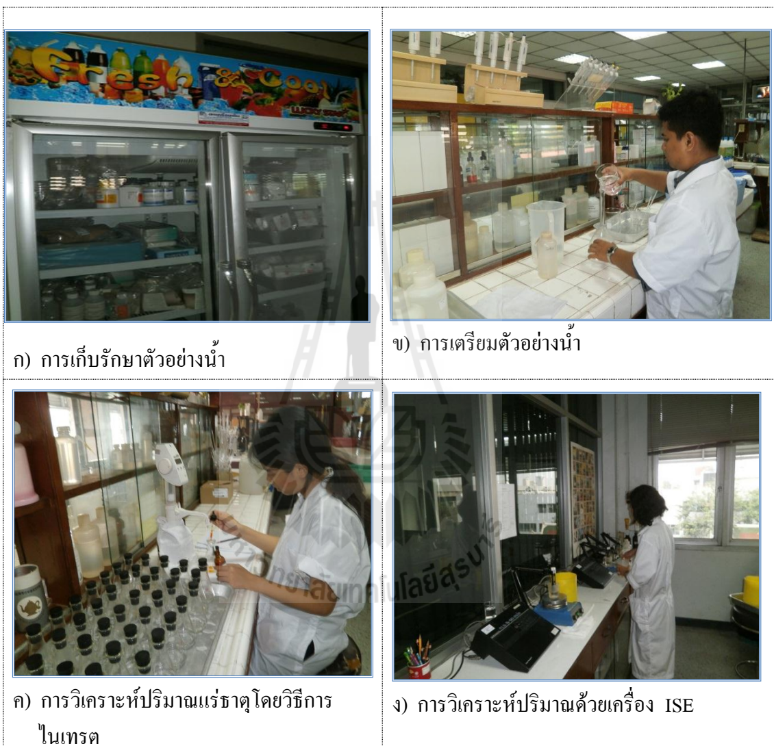
รูปที่ 3.2 ขั้นตอนและวิธีการทดสอบคุณภาพน้ำในห้องปฏิบัติการ
