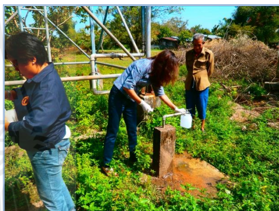
ง) เก็บตัวอย่างน้ำเพื่อทำการวิเคราะห์ เคมี - กายภาพ
