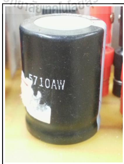
รูปที่ 5.7 ตัวเก็บประจุของวงจรแปลงผันแบบบักก์
