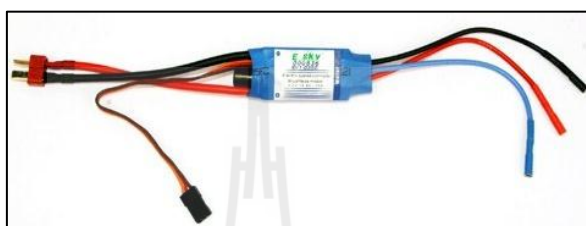
รูปที่ 2.36 แสดงชุดควบคุมความเร็วรอบแบบอิเล็กทรอนิกส์ (Electronic Speed Controller: ESC)
