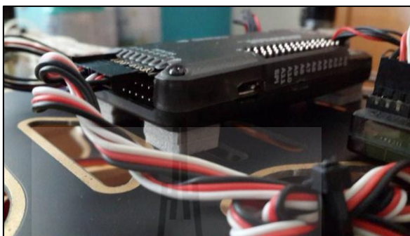
รูปที่ 4.6 แสดงการติดโฟมเพื่อลดการสั้นสะพานของ Control Board
