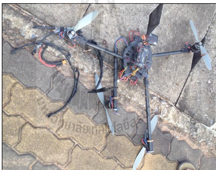
รูปที่ 4.17 แสดงความเสียหายที่เกิดจากการตกในกรณีที่ 7
