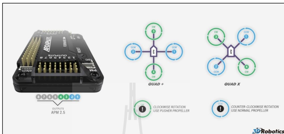
รูปที่ ก.4 แสดงรูปแบบการต่อช่อง Output ของอากาศยานสี่ใบพัด (ที่มา : http://copter.ardupilot.com/wiki/connecting-the-escs-and-motors/ )
