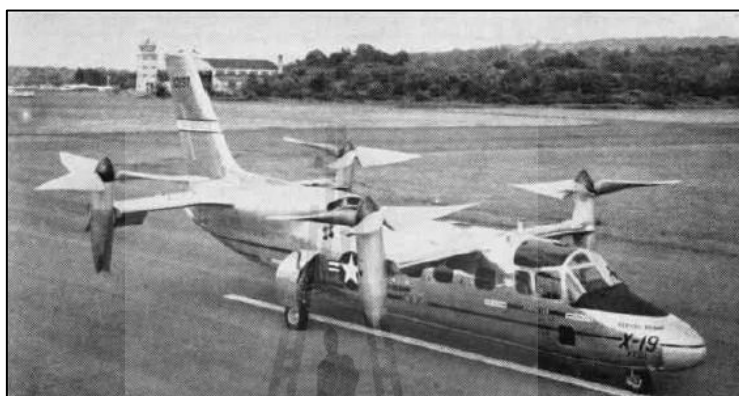
รูปที่ 2.5 แสดงอากาศยานแบบตีใบพัดแบบ Curtiss-Wright X-19
