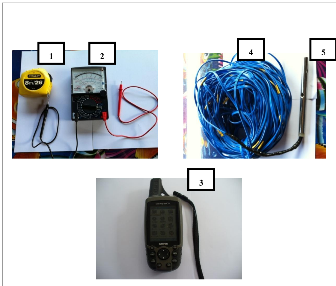
รูปที่ 3.2 อุปกรณ์ในการตรวจวัดระดับน้ำบาดาล (1) ตลับเมตร (2) เครื่องโอมมิเตอร์ (3) เครื่อง GPS (4) สายไฟ (5) หัวจุ่มวัดระดับน้ำ
