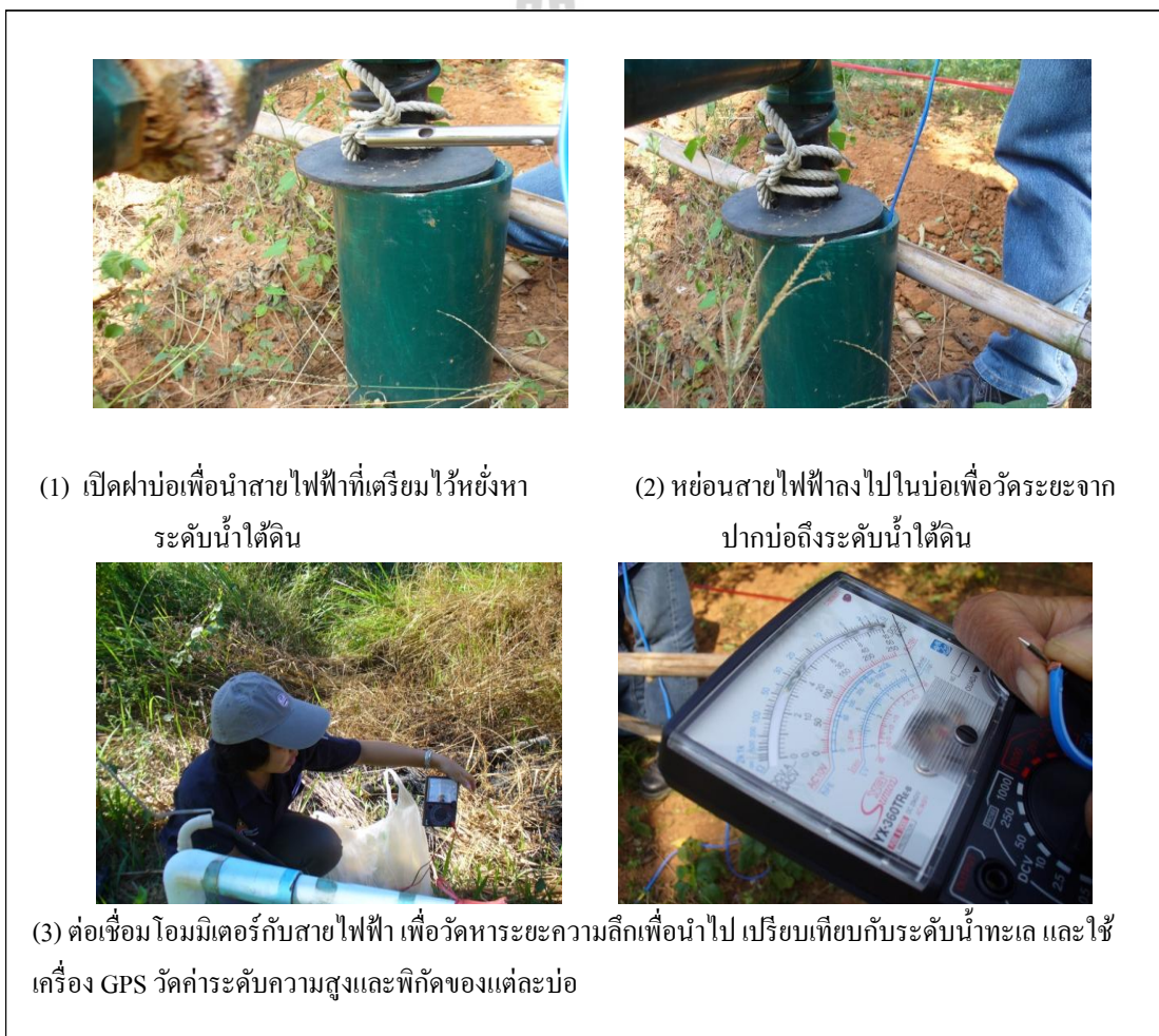
รูปที่ 3.3 ขั้นตอนในการตรวจวัดระดับน้ำบาดาล (1) บ่อน้ำบาดาล (2) หยั่งหาระดับน้ำ (3) ใช้ GPS วัดค่าพิกัด
