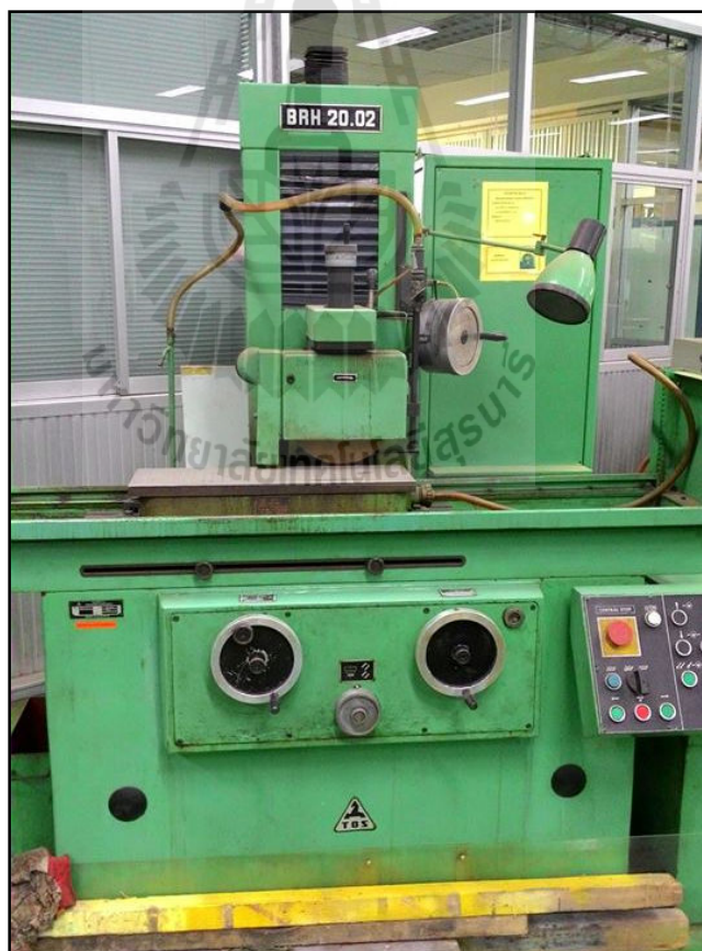
รูปที่ 3.2 เครื่องเจียรนัยราบผิวงาน Horizontal Surface Grinders (BRH20.02)
