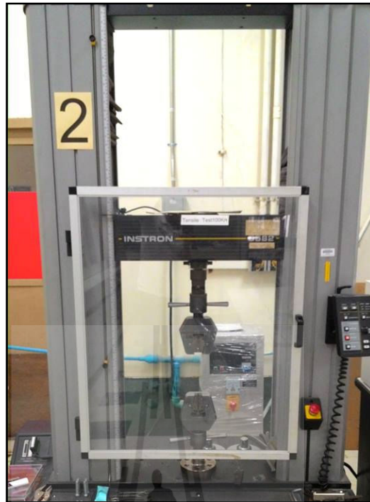
รูปที่ 3.7 เครื่องทดสอบแรงดึงเหนือ Universal testing Machine ยี่ห้อ Instron รุ่น 5582 (100kN)
