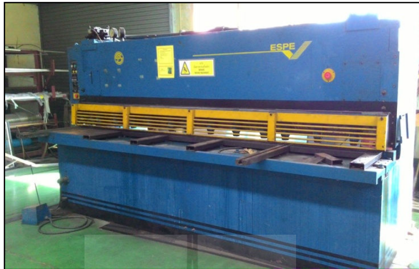
รูปที่ 3.1 เครื่องตัดโลหะแผ่น Hydraulic Guillotine Shears (CNTA3150/63A)
