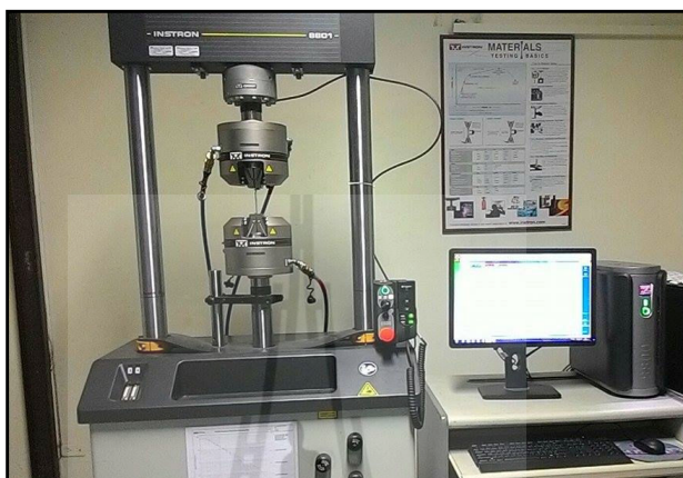
รูปที่ 4.4 เครื่องทดสอบความล้า INSTRON 8801
