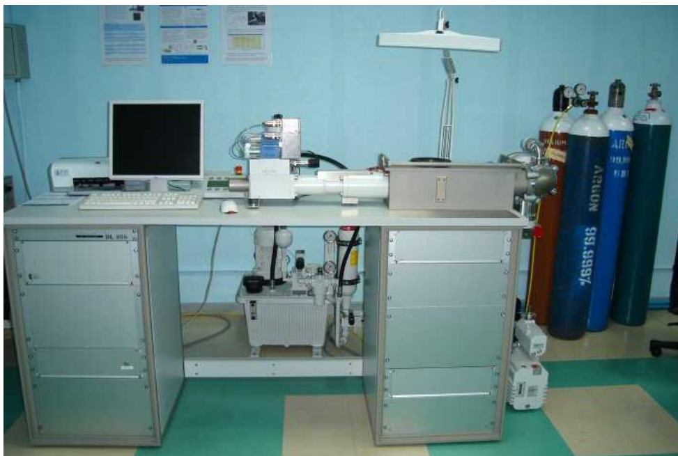
รูปที่ 2.21 เครื่องโดปลาโตมิเตอร์ที่สถาบันเหล็กและเหล็กกล้าแห่งประเทศไทย (เอกสารของศูนย์เครือข่ายวัสดุวิเคราะห์วิจัยอุตสาหกรรม)
