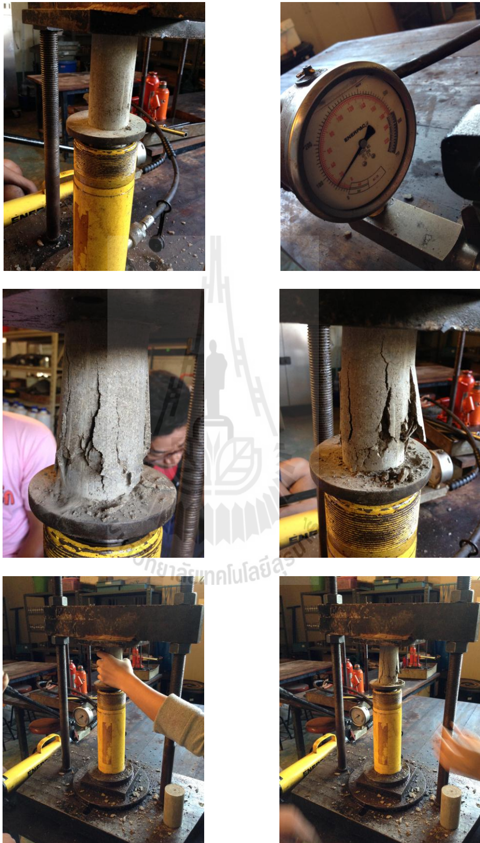
รูปที่ 3.3 การทดสอบกำลังอัดในแกนเดียวของก้อนตัวอย่างดินตะกอนประปาจิโพลิเมอร์
