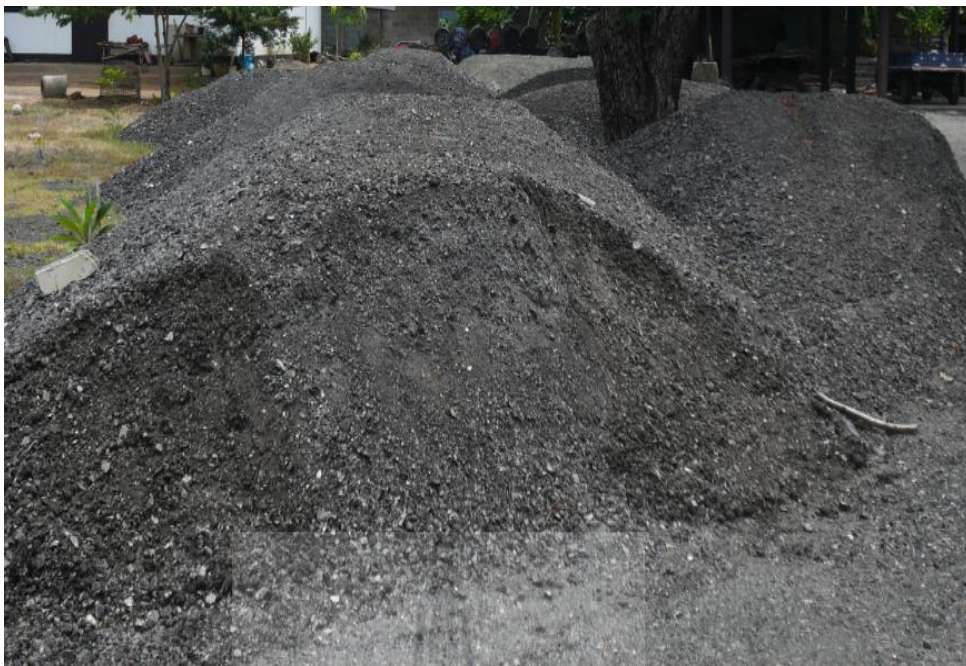
รูปที่ 1 ตัวอย่างหินคลุกซีเมนต์พื้นทางเดิม
