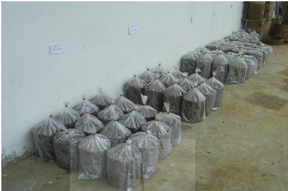
รูปที่ 5 ปมตัวอย่างหินคลุกซีเมนต์พื้นทางเดิมผสมผิวแอสฟัลต์คอนกรีตเดิม
