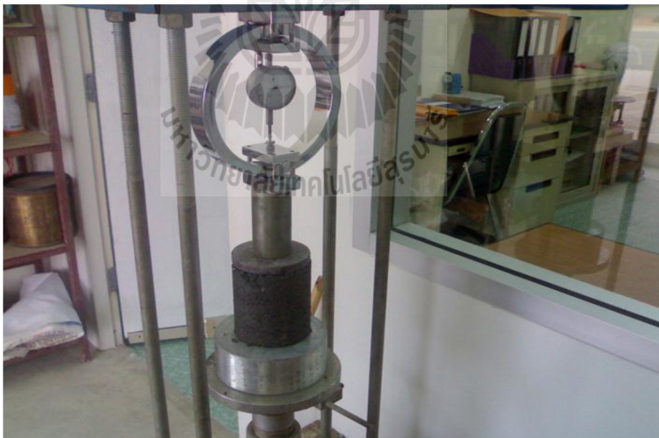
รูปที่ 6 การทดสอบกำลังรับแรงอัดแกนเดียว
