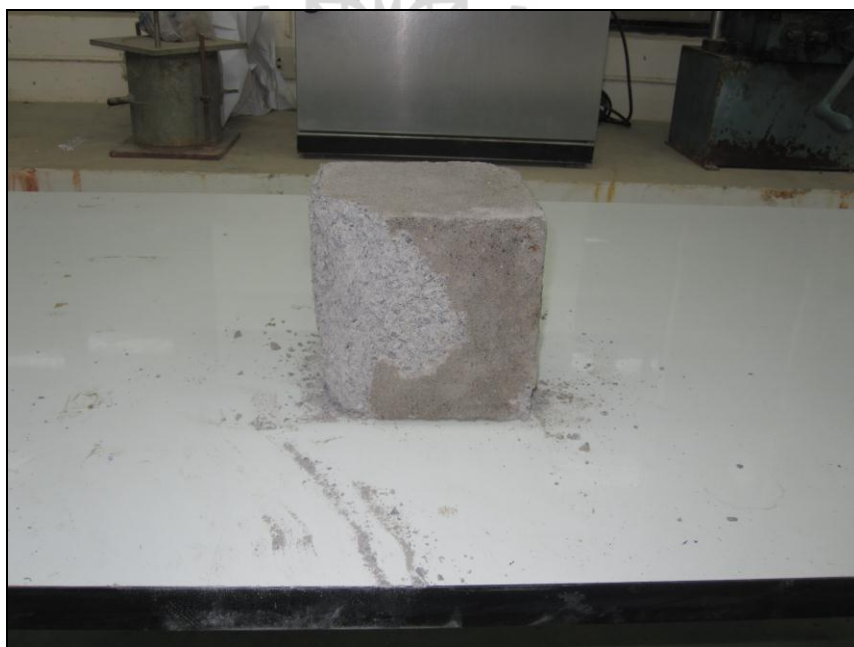
รูปที่ ค.24 การวัดของแท่งตัวอย่าง 40:60 W/B 0.75
