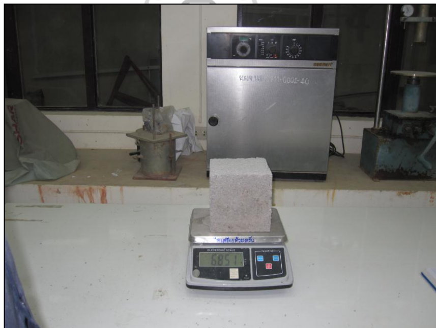
รูปที่ ค.13 การชั่งน้ำหนักตัวอย่างคอนกรีต 80:20 W/B 0.75
