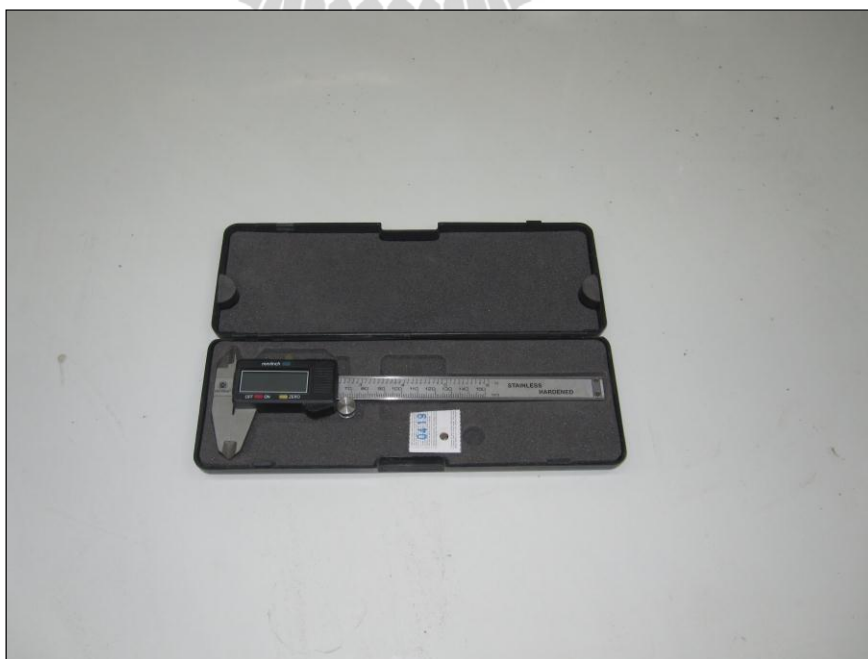
รูปที่ 3.8 เครื่องมือวัดขนาดแท่งตัวอย่างคอนกรีตบล็อก (Venire)
