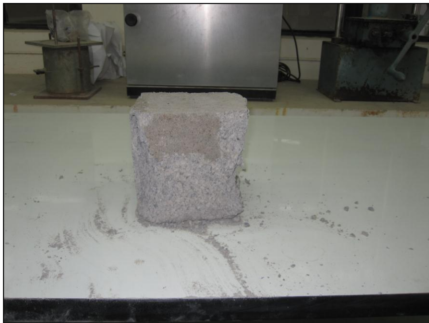
รูปที่ ค.25 การวิบัติของแท่งตัวอย่าง 80:20 W/B 1.00
