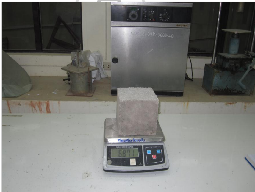
รูปที่ ค.17 การชั่งน้ำหนักตัวอย่างคอนกรีต 60:40 W/B 1.00
