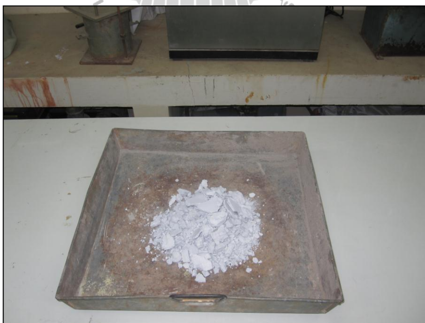
รูปที่ 3.1 ตัวอย่างกากเคลเซียมคาร์ไบด์ก่อนผสม
