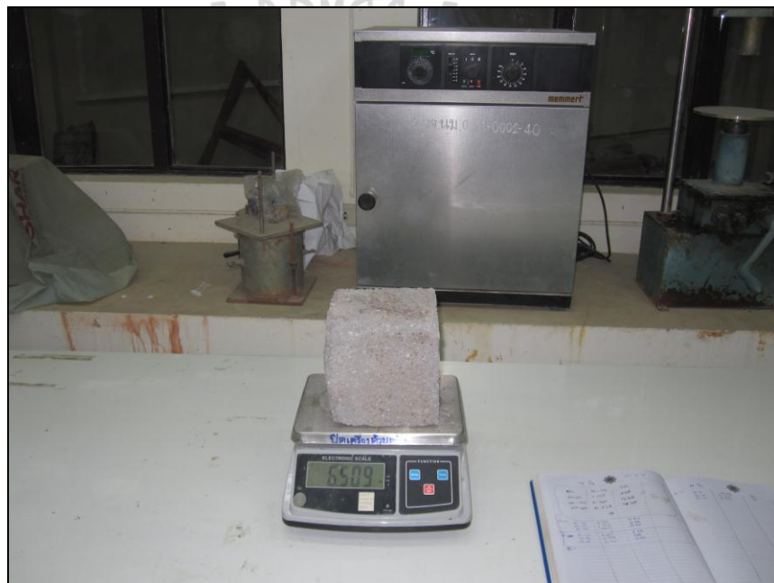
รูปที่ ค.11 การชั่งน้ำหนักตัวอย่างคอนกรีต 60:40 W/B 0.50
