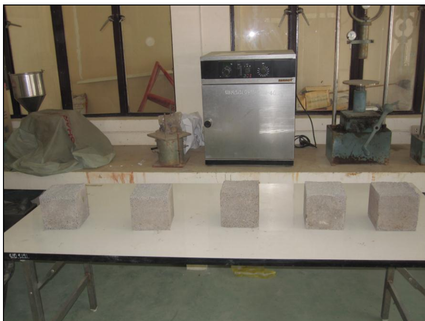
รูปที่ ค.5 แท่งตัวอย่างคอนกรีตปลีอก 60:40 W/B=0.75
