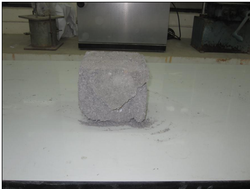
รูปที่ ค.19 การวิบัติของแท่งตัวอย่าง 80:20 W/B 0.50
