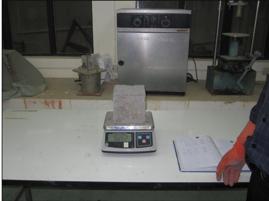
รูปที่ ค.10 การชั่งน้ำหนักตัวอย่างคอนกรีต 80:20 W/B 0.50
