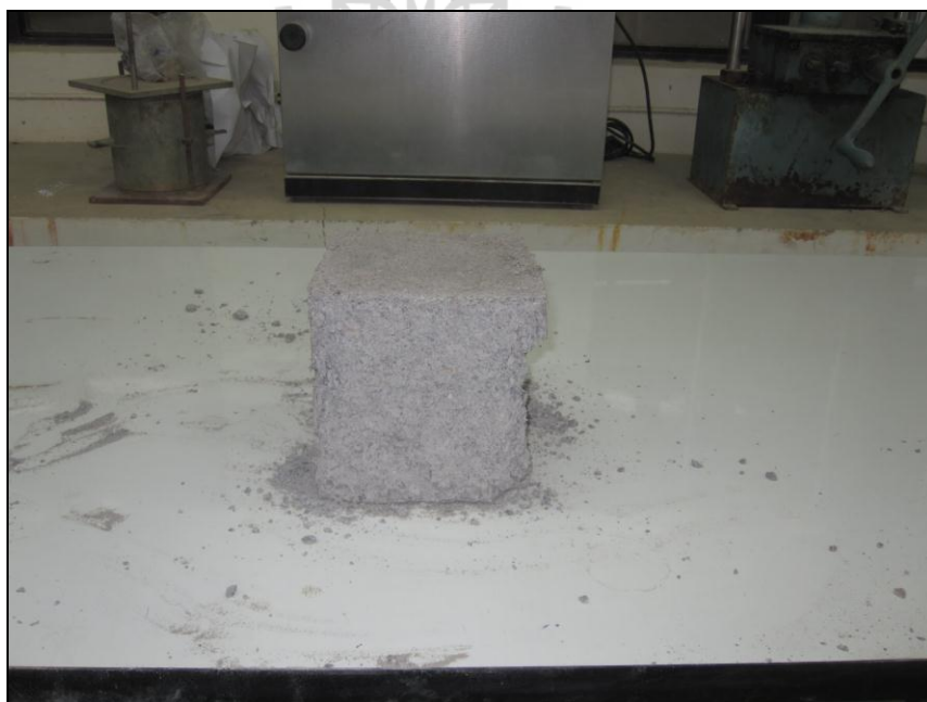
รูปที่ ค.26 การวิบัติของแท่งตัวอย่าง 60:40 W/B 1.00
