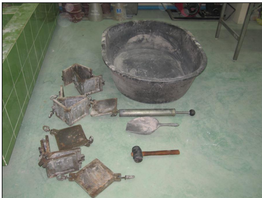
รูปที่ 3.5 แบบหล่อตัวอย่างเครื่องมือและอุปกรณ์ผสมคอนกรีต
