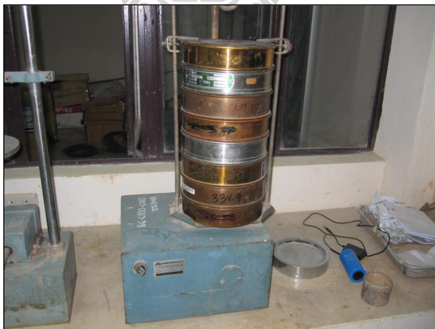
รูปที่ 3.6 ชุดทดสอบขนาดของตัวอย่าง (Seive)
