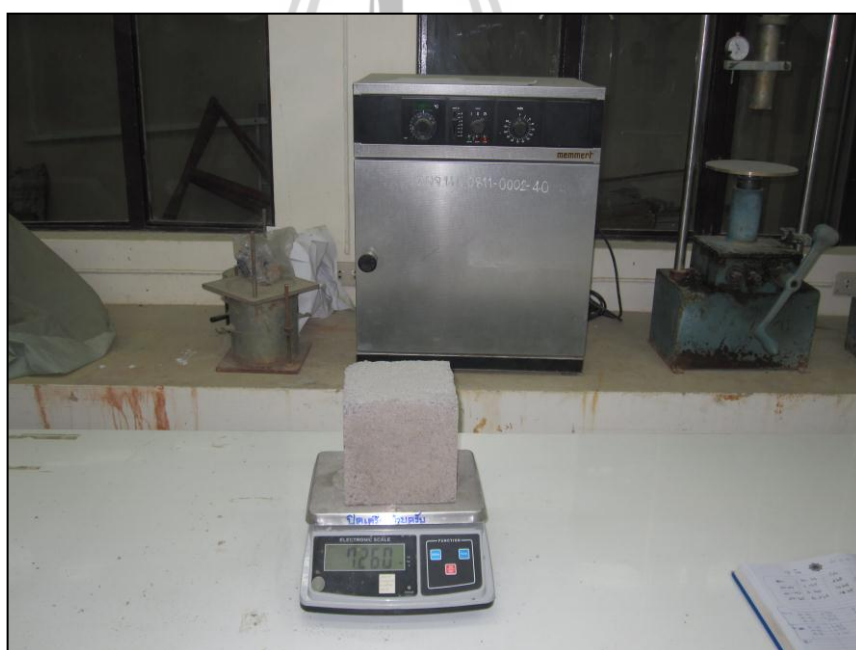
รูปที่ ค.15 การชั่งน้ำหนักตัวอย่างคอนกรีต 40:60 W/B 0.75
