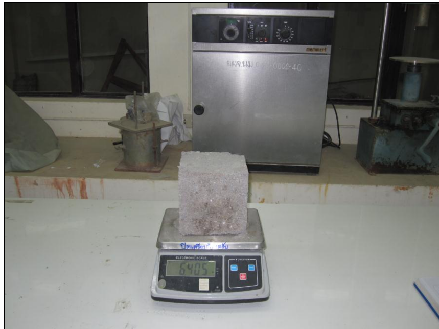
รูปที่ ค.12 การชั่งน้ำหนักตัวอย่างคอนกรีต 40:60 W/B 0.50
