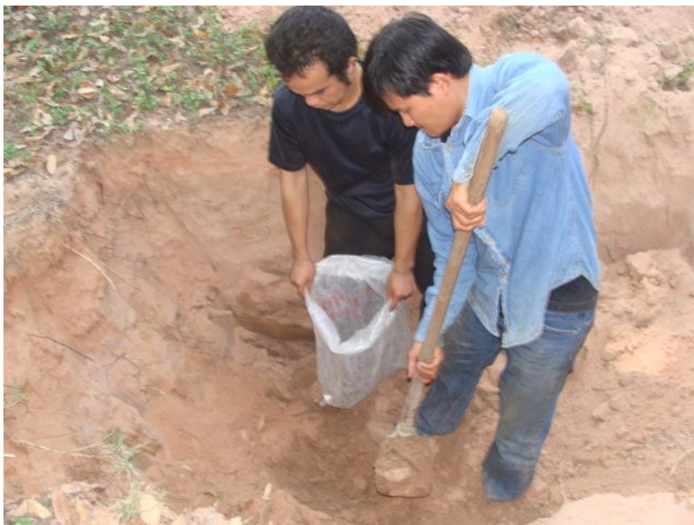
รูปที่ 4.2 การเก็บตัวอย่างดินที่ความลึก 1 เมตร
