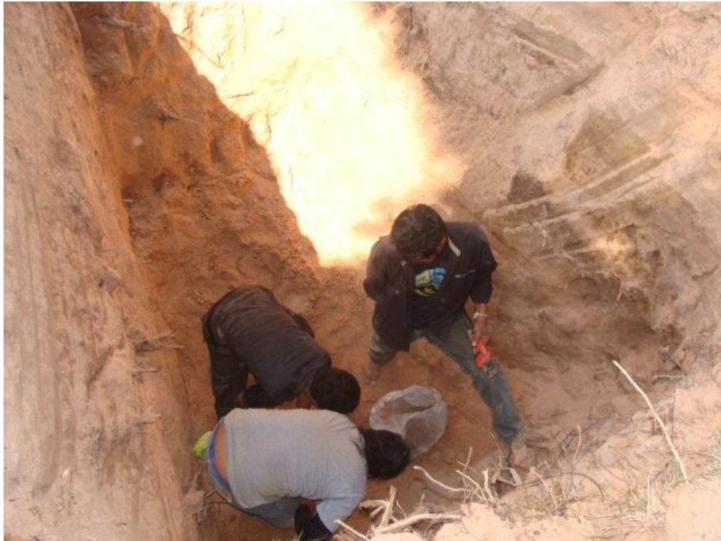
รูปที่ 4.3 การเก็บตัวอย่างดินที่ความลึก 3 เมตร
