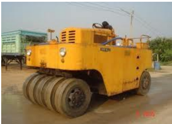
รูปที่ 2.5 รถบดล้อยางทำงานด้วยระบบความดันลม (pneumatic-tired roller)
