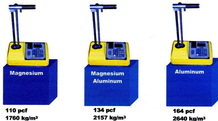
รูปที่ 2.19 การทำ Calibration ของเครื่องมือ โดยทดสอบบนวัสดุที่รู้ค่าความหนาแน่นที่แน่นอน
