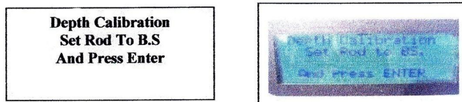
รูปที่ 2.24 จอแสดงการ Calibrate ตำแหน่งของแท่งรังสี
