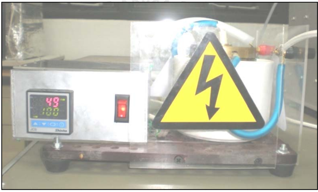
รูปที่ 3.16 ชุดควบคุมอุณหภูมิ
