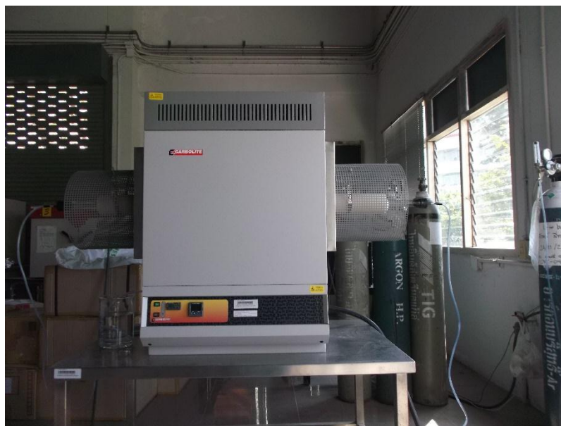
รูปที่ 3.10 เตาไฟฟ้าที่ใช้ในการเผาให้ความร้อนสารประกอบ \text{Li}_2\text{FeSiO}_4/\text{C}
