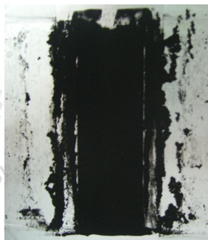
รูปที่ 3.19 (a) การเตรียมแผ่นอลูมิเนียมบางสำหรับเตรียมอิเล็กโทรด (b) สารที่ผสมกันดีแล้ว ปาดลงบนแผ่นอลูมิเนียมบางด้วยใบมีด
