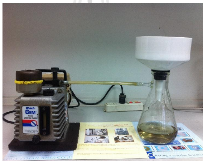
รูปที่ 3.15 ขั้นตอนการกรองสารด้วยปั๊มสุญญากาศ
