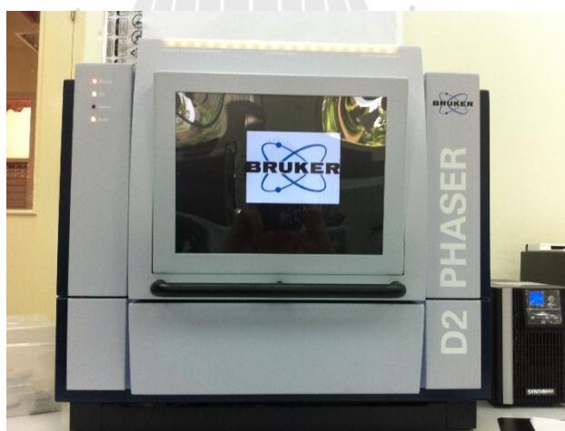
รูปที่ 3.17 เครื่อง X-ray diffractometer ยี่ห้อ Bruker รุ่น D2 ที่ศูนย์เครื่องมือวิทยาศาสตร์และเทคโนโลยี มหาวิทยาลัยเทคโนโลยีสุรนารี
