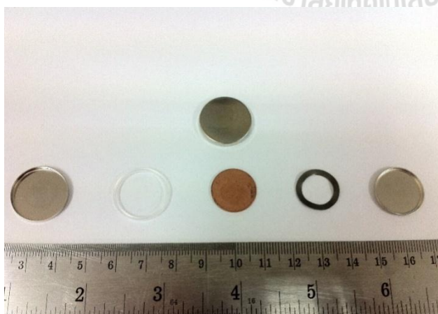
รูปที่ 3.20 (a) ส่วนประกอบต่างๆ ของแบตเตอรี่แบบกระดุม (coin cell battery) (b) ชั้นของวัสดุที่ประกอบอยู่ในแบตเตอรี่แบบกระดุม
