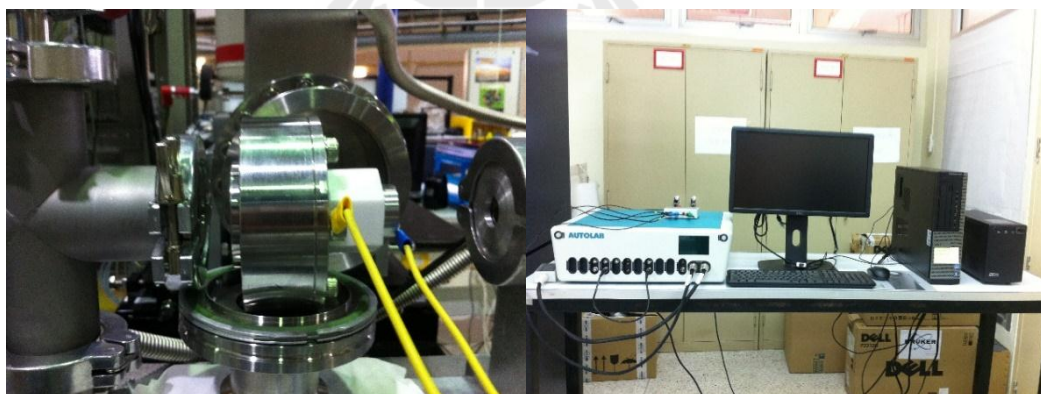
รูปที่ 3.25 (a) ภาพการติดตั้งมอเตอร์ที่ออกแบบสำหรับวัด in-situ XAS แบบทะลุผ่าน โดยลูกศร แสดงถึงทิศทางของแสงซินโครตรอนที่ทะลุผ่านตัวอย่างในระหว่างกระบวนการชาร์จ และดิสชาร์จ (b) ชุดอุปกรณ์สำหรับวัดและเก็บข้อมูลกระบวนการชาร์จและดิสชาร์จของ มอเตอร์ที่ออกแบบสำหรับวัด in-situ XAS แบบทะลุผ่าน
