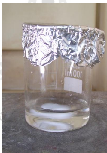
รูปที่ 3.6 ผสม Pluronic®P-123 ในสารละลาย absolute alcohol จนได้สารละลายใส
