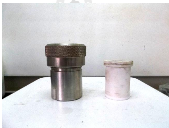
รูปที่ 3.13 Teflon และ stainless steel autoclave สำหรับกระบวนการสังเคราะห์แบบ hydrothermal synthesis
