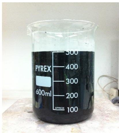
รูปที่ 3.14 สารละลาย \text{Li}_2\text{FeSiO}_4/\text{C} ผ่านกระบวนการ hydrothermal synthesis ที่อุณหภูมิ 180 องศาเซลเซียสเป็นเวลา 12 ชั่วโมง
