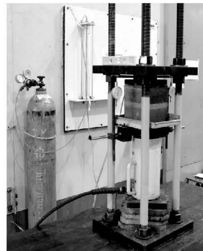
รูปที่ 12 การจัดเตรียมอุปกรณ์ที่ใช้ทดสอบความซึมผ่านของส่วนผสมในรอยแตกที่เปิดแยก
